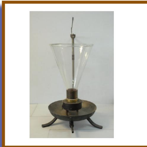
021.- Balanza para principio de Arquímedes
