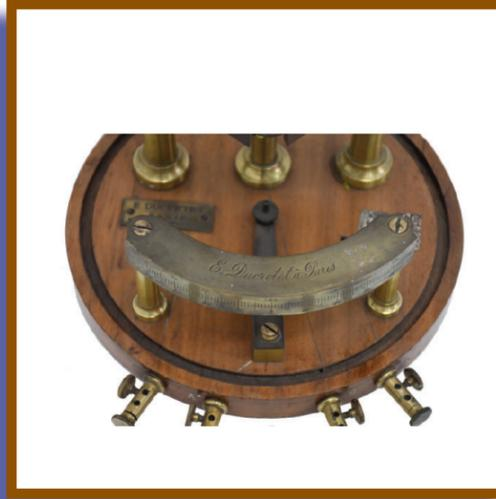
036.- Galvanómetro / bobina de inducción
